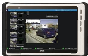
Il monitor centrale Touch panel consente di gestire l'intero sistema e si posiziona a fianco del conducente, visualizzare le immagini e gli eventi di allarme, effettuare ricerche sulla banca dati esterne ed interne e programmare il sistema.
